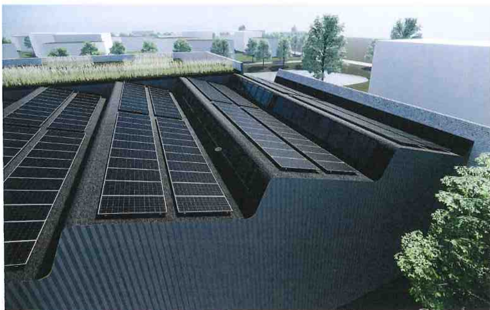
På sågtandstakets södersida monteras solceller och på uppviket mot norr monteras dagljus till lagerverksamheten.
